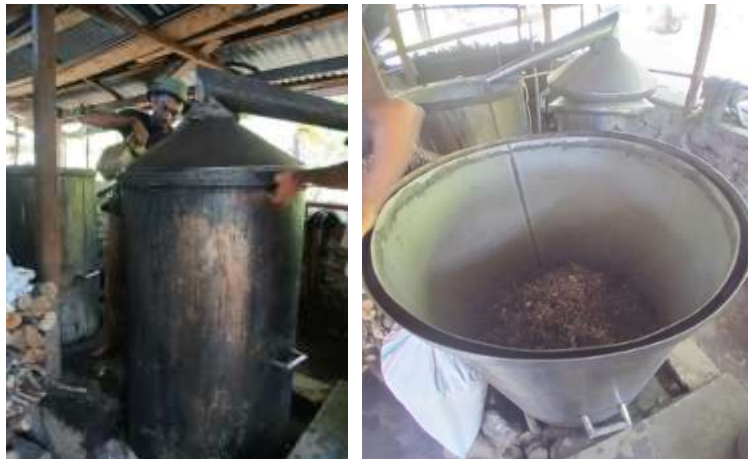
Gambar 4. Pemasakan Minyak Cengkeh KUPS Baramakusu
