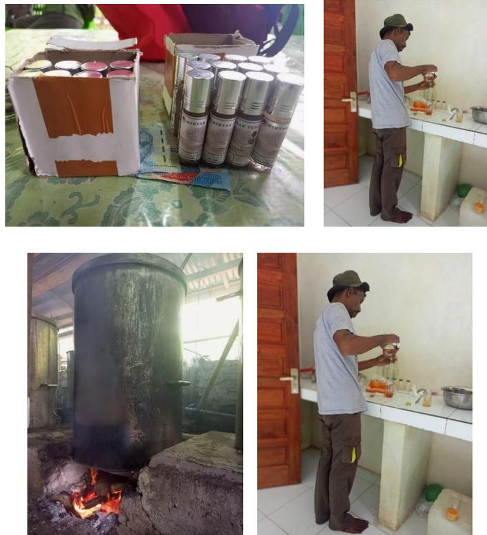
Gambar 1. Proses Produksi Minyak Atsiri Cengkeh. a) Produk Minyak Atsiri Cengkeh, b) Proses Pemisahan Minyak dengan air, c) pemasakan minyak atsiri, d) pengemasan minyak atsiri
